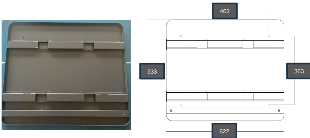
Imagem 10 – Fixação de base auxiliar para suporte do produto
