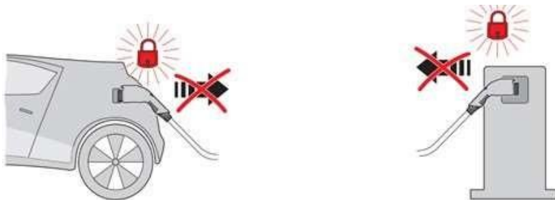
Imagen 4 – No romo el enchufe del cargador durante la recarga
